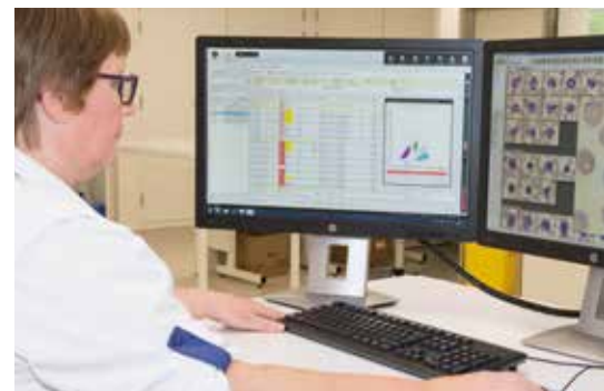
Laborant voert een microscopisch nazicht uit van de WBC-formule op de digitale microscoop (rechts) en stemt deze af met de resultaten in het expertsysteem (links).
